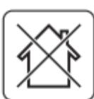
Изделие предназначено для эксплуатации ТОЛЬКО вне помещений. Топливо, используемое в двигателе изделия, является огнеопасным. Во избежание возгораний, травм и повреждения имущества строго соблюдайте правила обращения с огнеопасными материалами.
